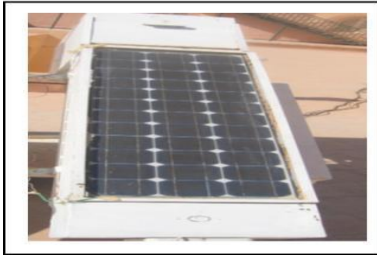
Figure.I.4. Photo du capteur hybride étudié par TOUAFEK et al. [5]
