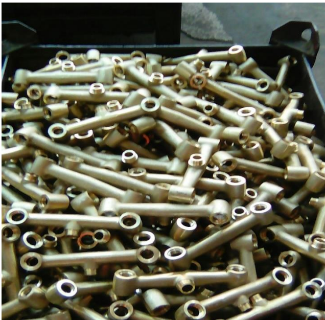
Figure IV.8 : les pièces après meulage et filetage
