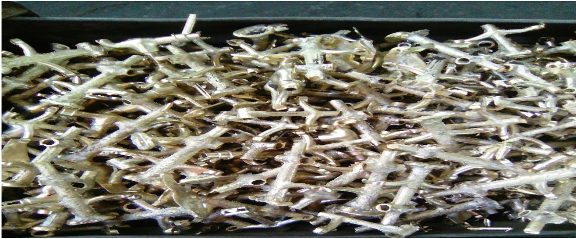
Figure IV.7 : les pièces après le tronçonnage
