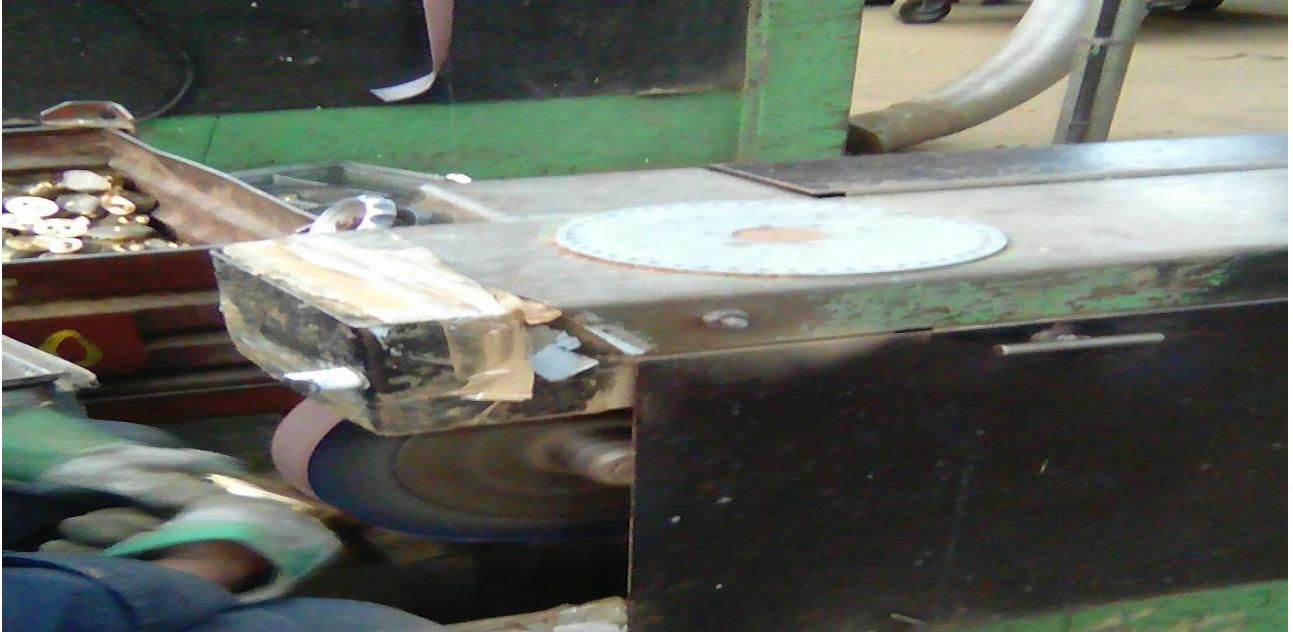
Figure IV.10 : meuleuse à bandes abrasives
