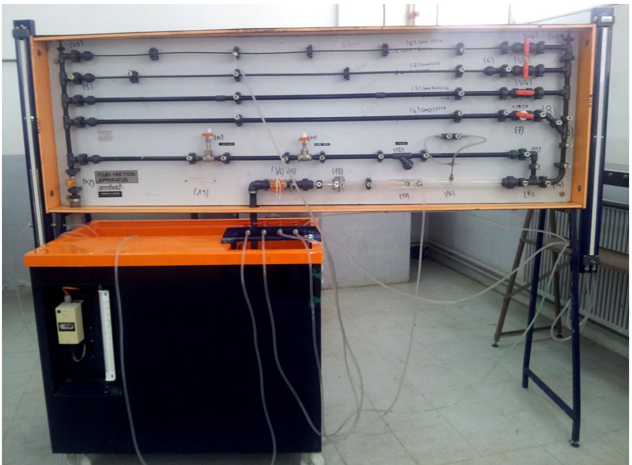
Figure III.1: Photo de l'installation expérimentale: ARMFIELD (C6-00 FLUID FRICTION APPARATUS).
