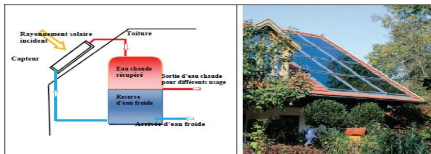
Figure II.1: Schéma de principe de l'utilisation de l'énergie solaire thermique (gauche) et photo d'un capteur solaire sur le toit d'une habitation (droite).
