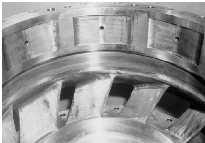
Figure 1.1: Coussinet du palier hybride d'une pompe primaire de réacteur nucléaire N4
