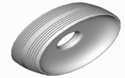
**Figure I.25 :** Modélisation d'une roue par balayage circulaire
