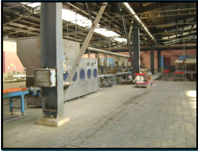
Figure (II-22): Tunnel de lavage et de séchage.
