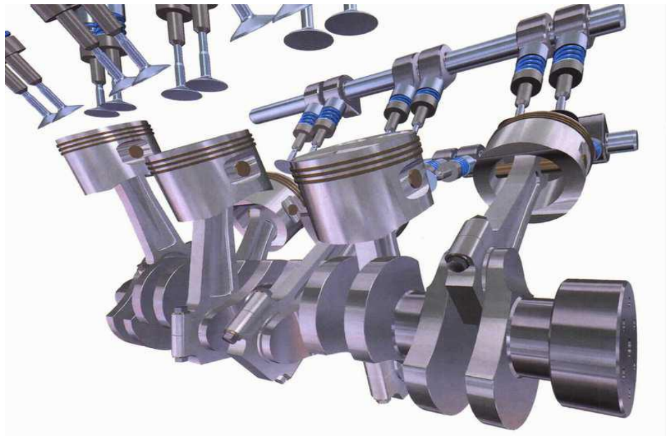
Figure I.1. Ensemble vilebrequin - bielles – pistons d'un moteur thermique 6 cylindres
