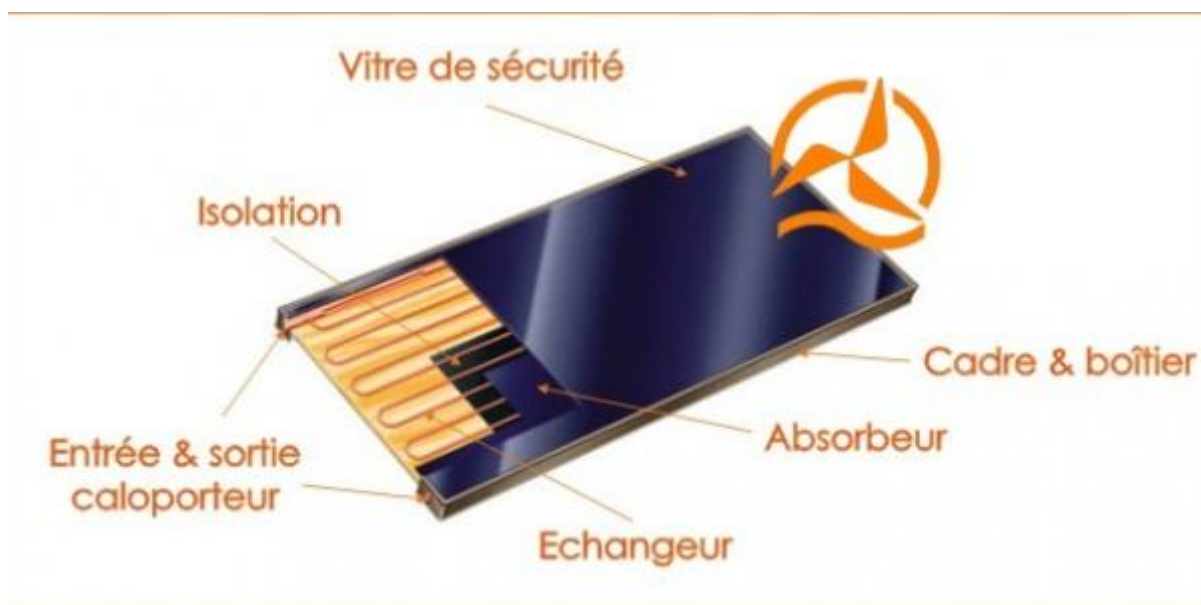
Figure I-18 : Capteurs plan vitré
