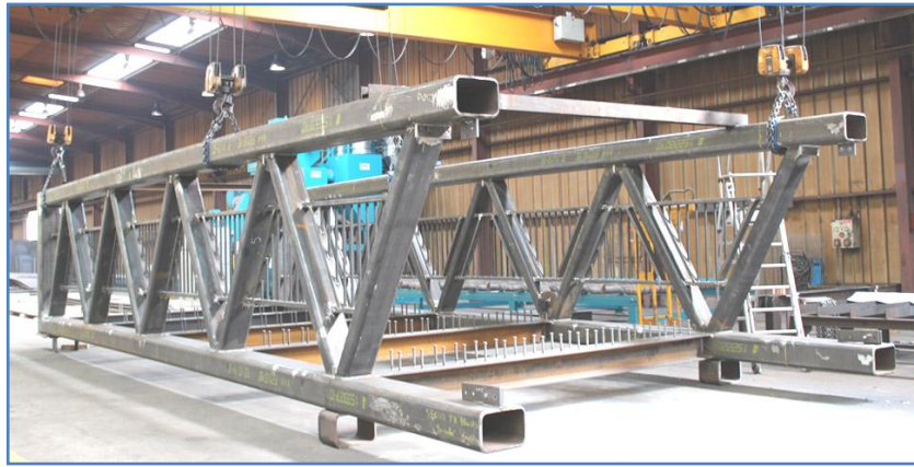
Figure 1.9 : Structure Métallique en PRS [10].
