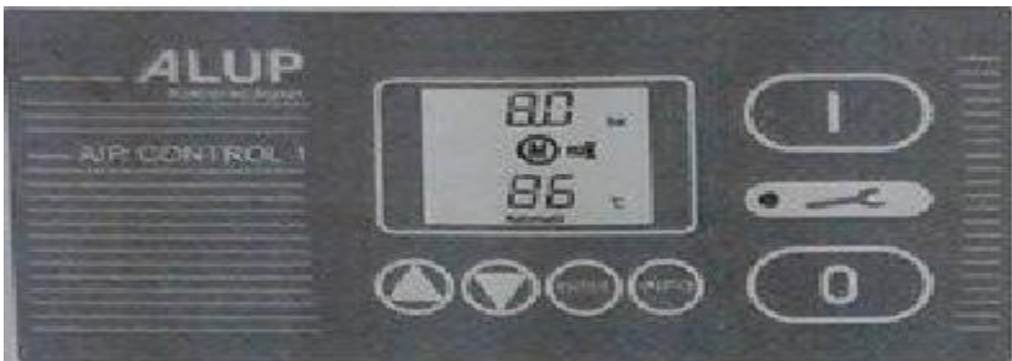
Figure III.3: Représentation de l'interface de commande du compresseur.
