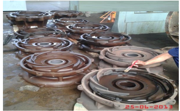
Figure 27 : diffuseurs de la pompe
