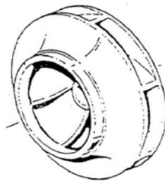
*FIGURE II-4 : ROUE DE POMPE CENTRIFUGE*
