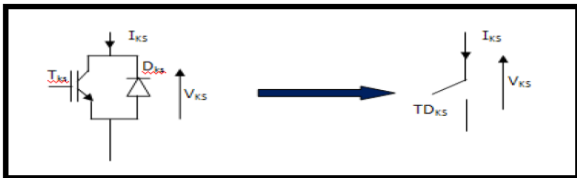
Figure III. 3 Interrupteur bidirectionnel équivalent de la paire Transistor – diode
