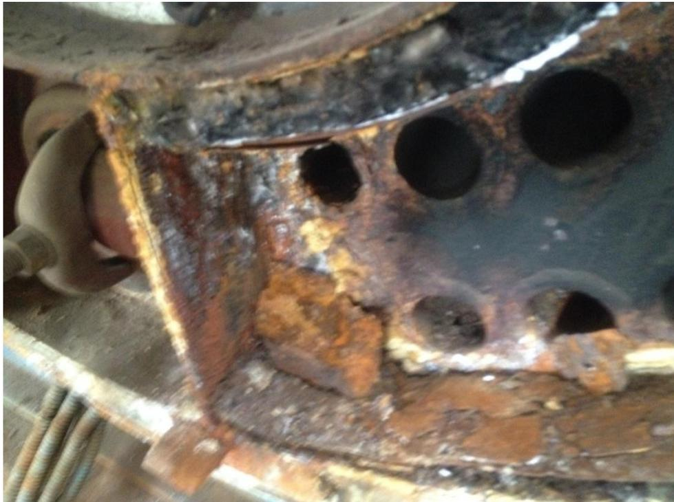
**Figure 2.7** la défaillance de la chaudière (corrosion au niveau des tuyauteries du foyer)
