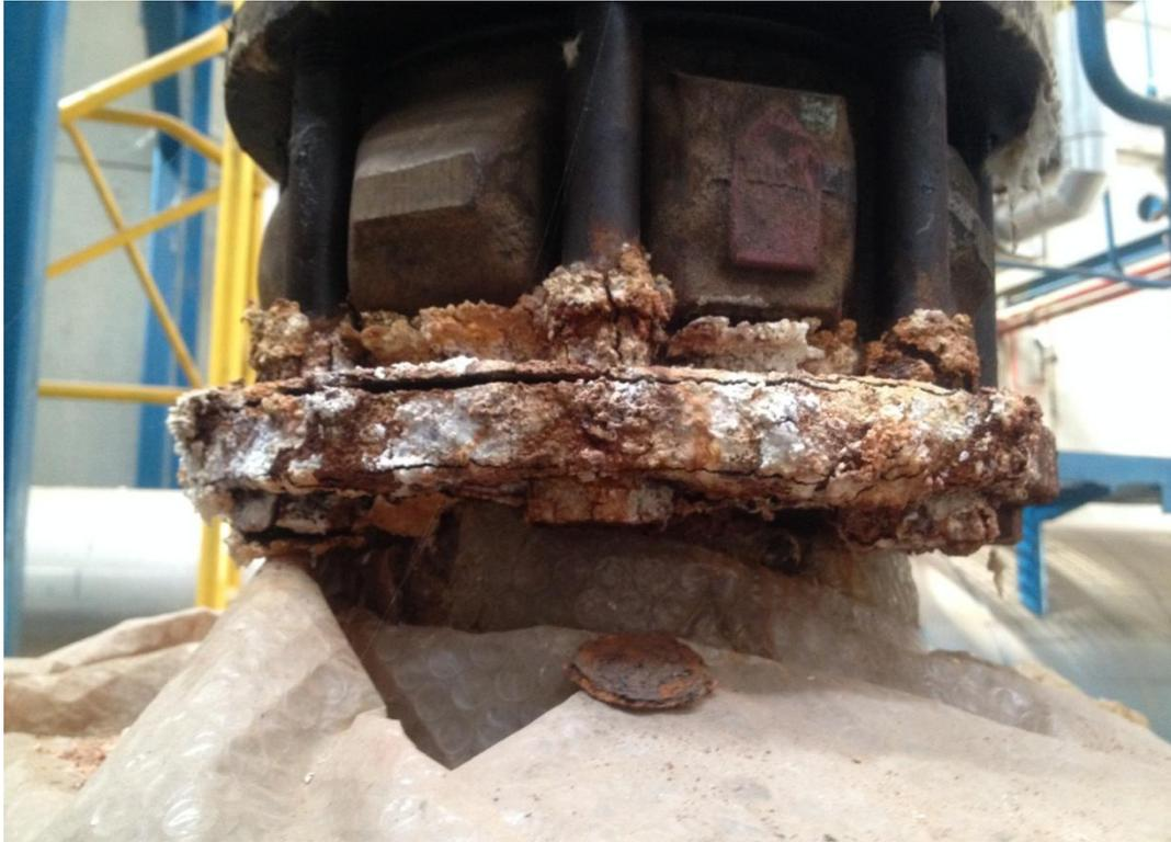
**Figure 2.8** la corrosion au niveau de la vanne de distribution
