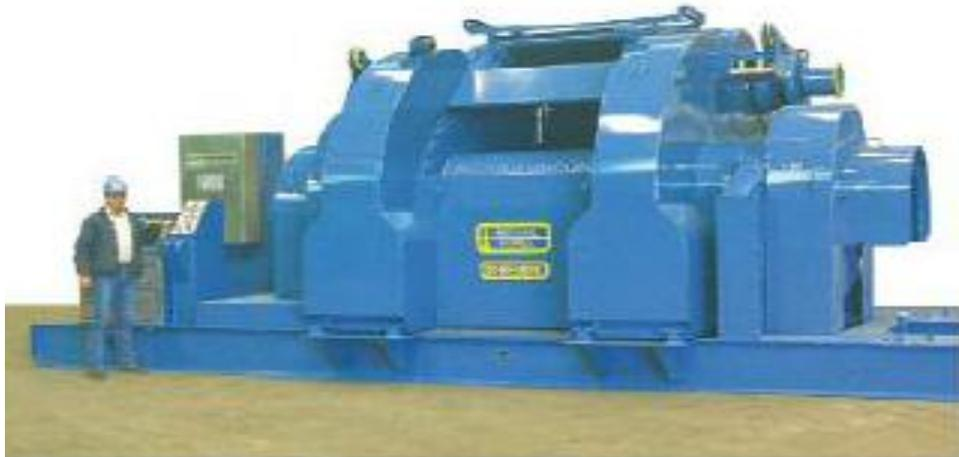
**Fig I.2 :** Le treuil de forage [2]
