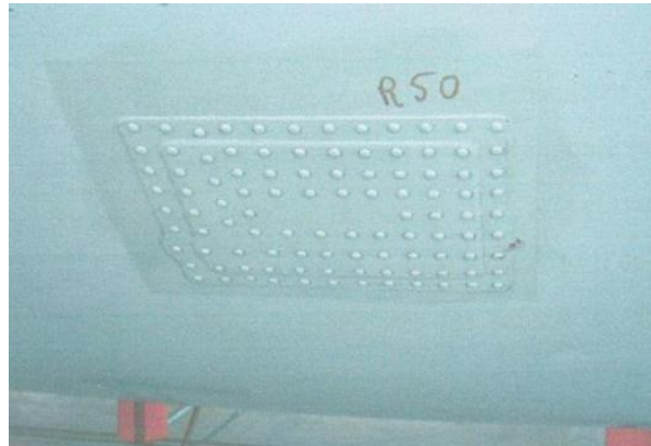
Figure. I.4 : Réparation par patch riveté sur fuselage de Boeing [7].
