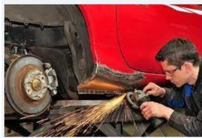
Figure. I.3 : Réparation par soudage.
