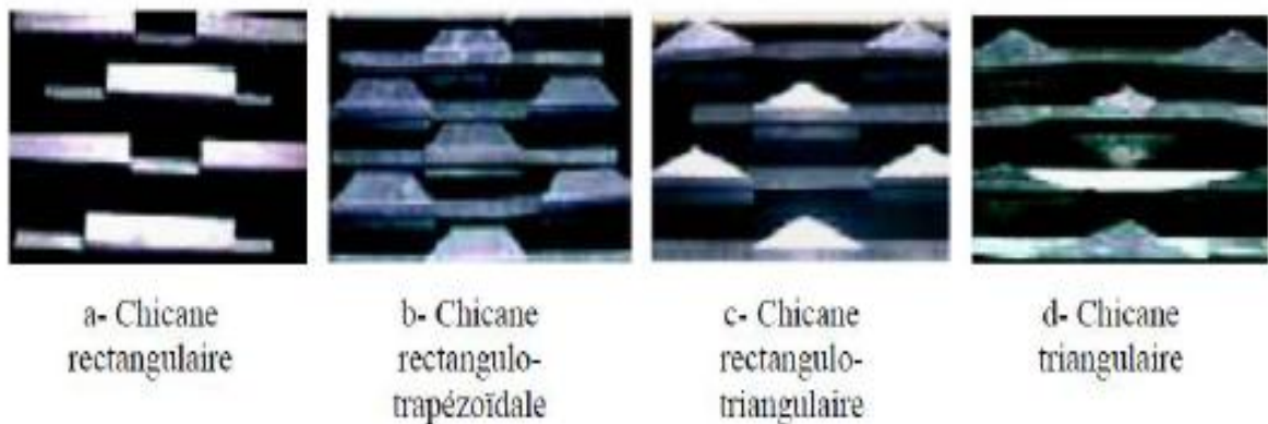
Figure II. 26 : Différentes configurations des chicanes testées par Chouchane et al.
