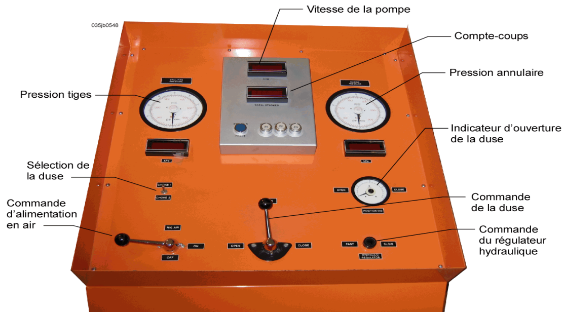
Fig.III.3 Panneau de commande d'une duse Swaco.
