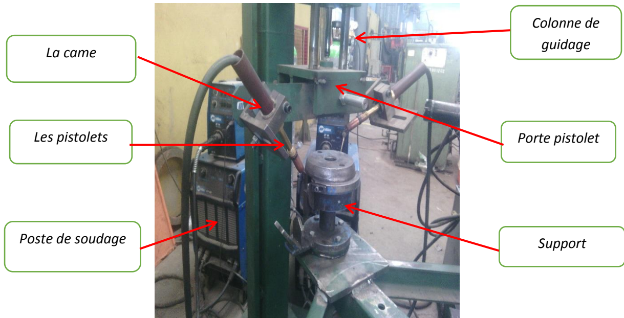
Figure II. 8: Poste de soudage des éclisses.
