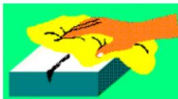
**Figure II.5:** Enlèvement de l'excès du pénétrant de la surface.
