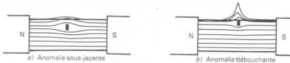
**Figure II.10:** Influence de la nature et la géométrie du défauts sur le gradient d'induction.
