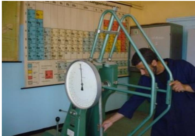
Figure I.5 : Laboratoire de contrôle de qualité. Machine de l'essai Charpy.
