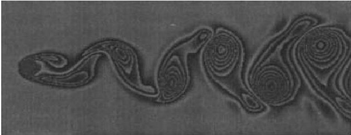
Figure I.9 : Champ de vorticité instantané, écoulement laminaire symétrique à Re = 180 , montrant l'allée de Von-Kármán, Persillon & Braza (1998) [39]
