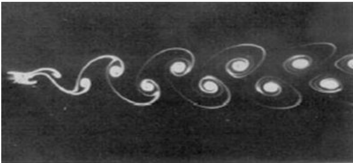
Figure I.8 : Écoulement instationnaire bidimensionnel à Re = 105 (Van Dyke [49], visualisation, S.Taneda).
