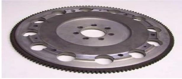
**Figure II.6 :** Le volant moteur [4]
