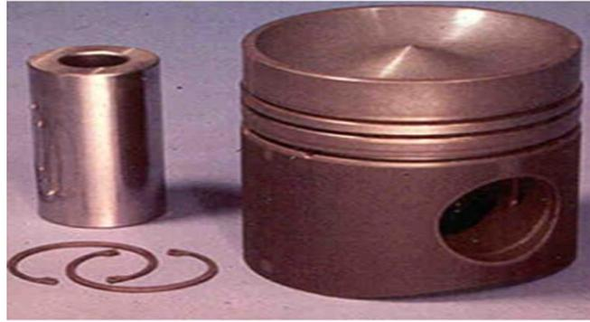
**Figure II.3 :** piston et axe de piston [5]
