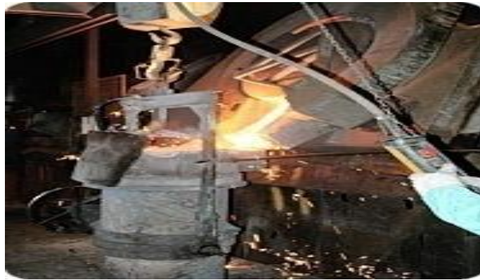
Figure IV.11 : Représente une vue de l'opération de vidange du four.
