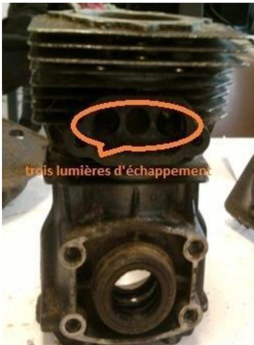
**Figure III.2 :** Cylindre complet avec les Trois lumières de d'échappement .
