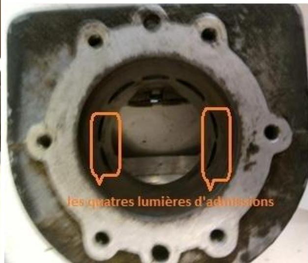
**Figure III.3 :** intérieur du cylindre avec quatre lumières d'admission, les trois Lumières d'échappement.
