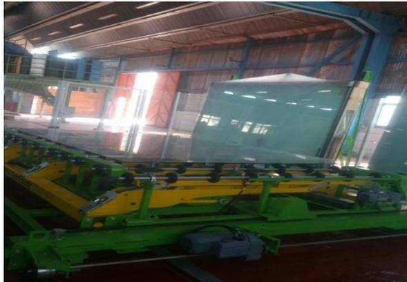
*Fig.III.3. Châssis de stockage et Dépileuse au sol*
