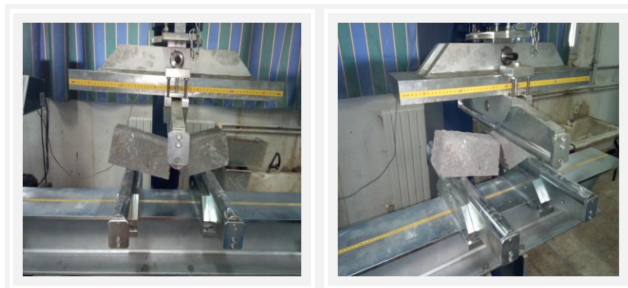
Figure (VI-4): Dispositif de chargement des poutres (prismes) (essai de traction par flexion trois points).
