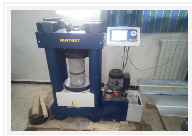
Figure (VI-3) : Dispositif de chargement des éprouvettes. (essai de compression)
