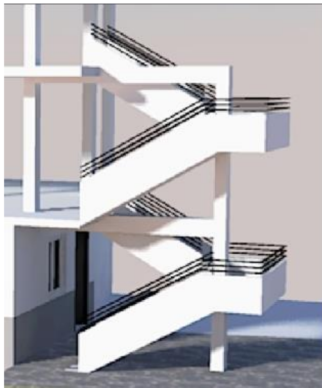
Figure I-5 : Exemple d'escalier droit à deux volées
