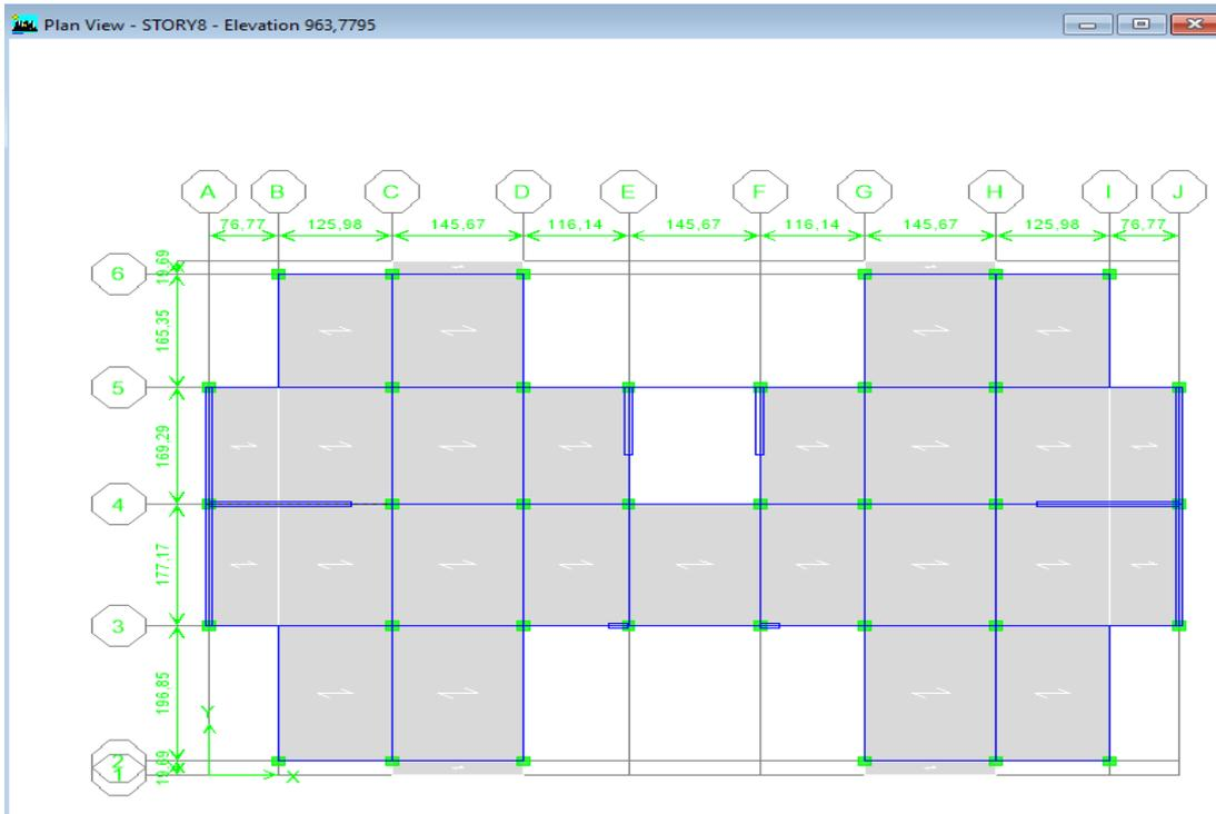
Fig. V.2 : Dispositions des voiles de contreventement après plusieurs variantes
