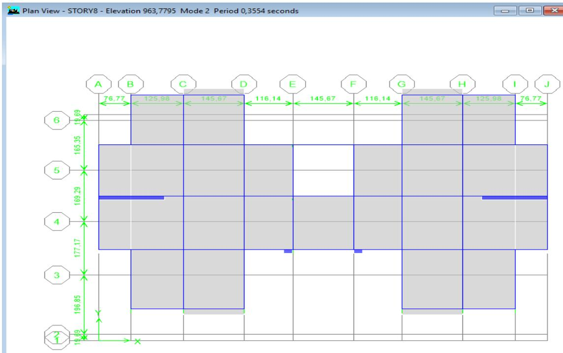
Fig. V.4 Analyse de la structure Mode 2 (translation)T=0,36s
