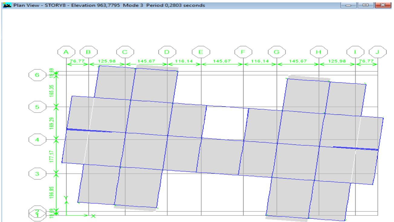
Fig. V.5 Analyse de la structure Mode 3 (rotation)T=0,28s
