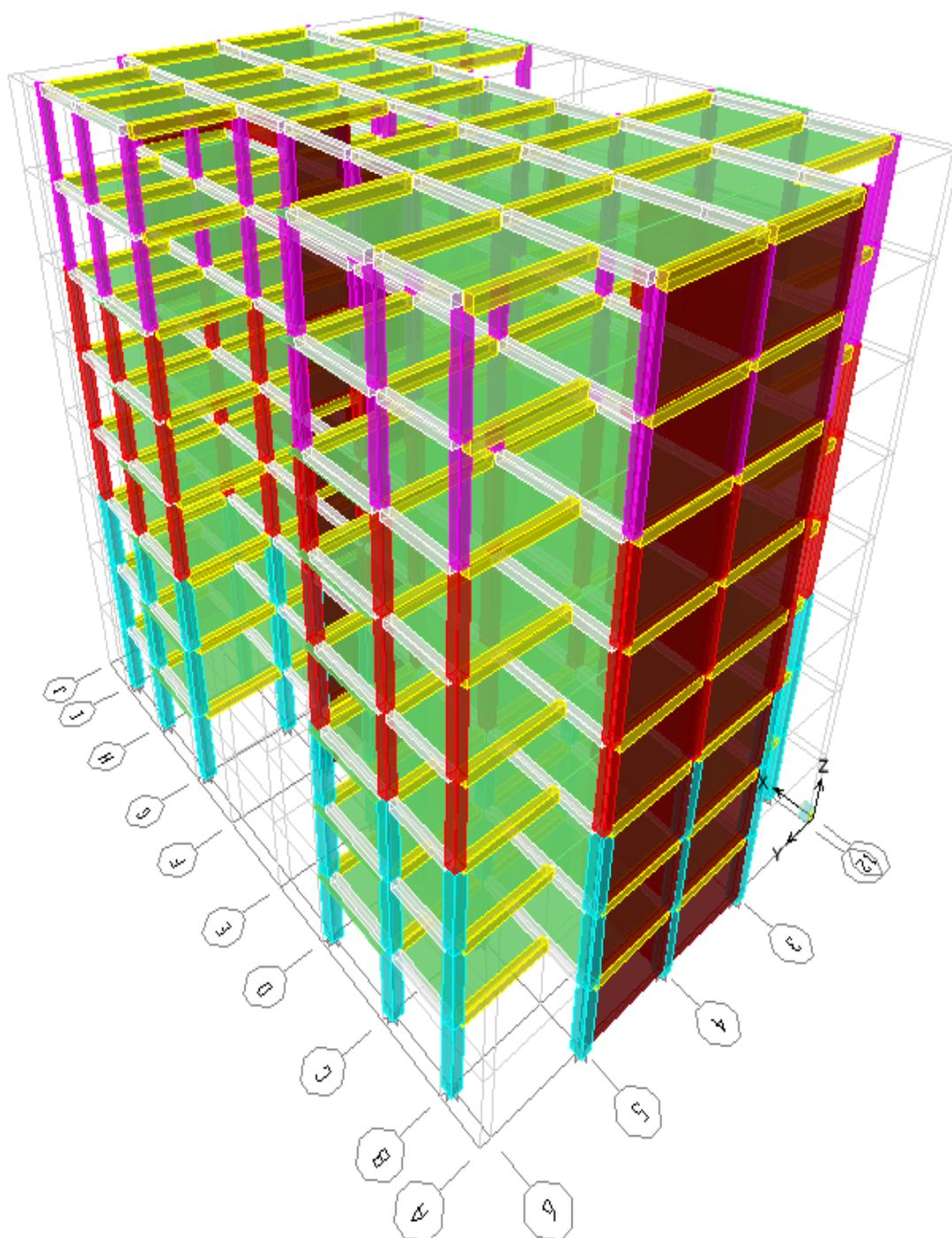
Figure .V.1 : Modélisation de la structure sous ETABS
