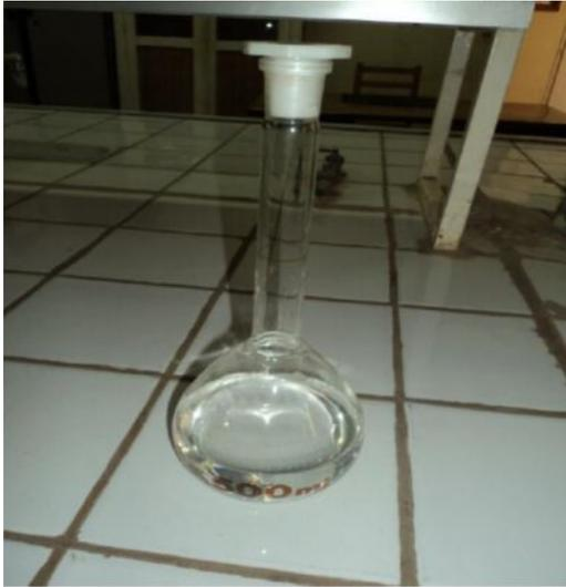
Figure III.13: Essai au pycnomètre
