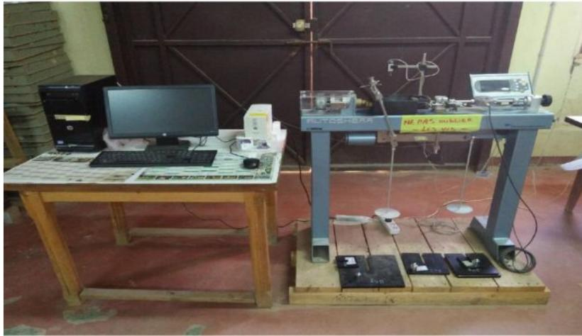
Figure III.19: Boîte de cisaillement carrée de Casagrande
