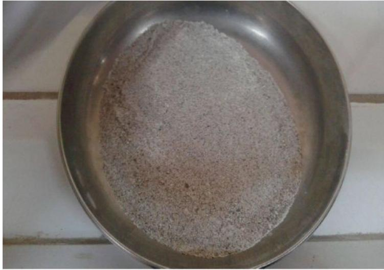
**Figure III.3:** Exemple d'un mélange sable-kaolin
