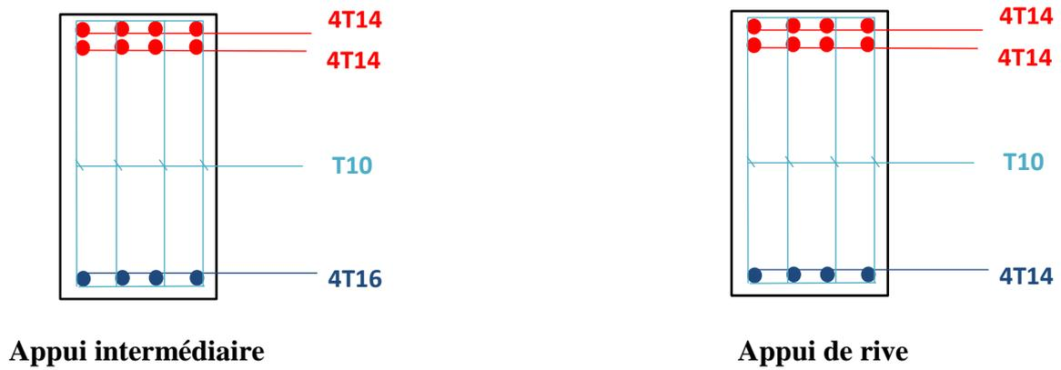
**Figure VIII.4 Ferrailage de la poutre de libage (sens transversal)**
