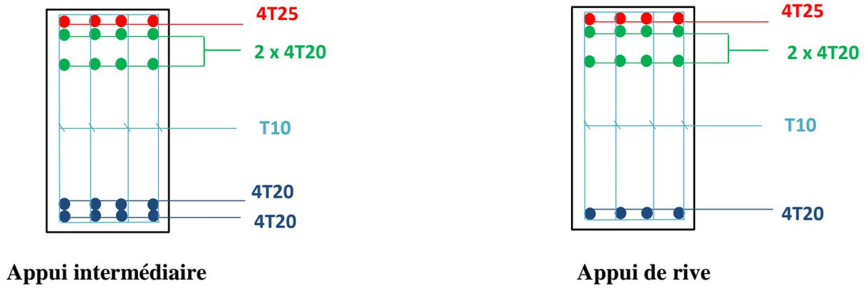
**Figure VIII.3 Ferrailage de la poutre de libage (sens longitudinal)**
