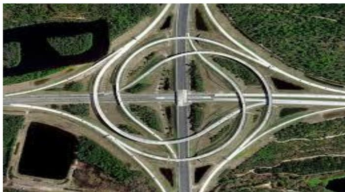
**Figure II.4 :** Échangeur en turbine complète
