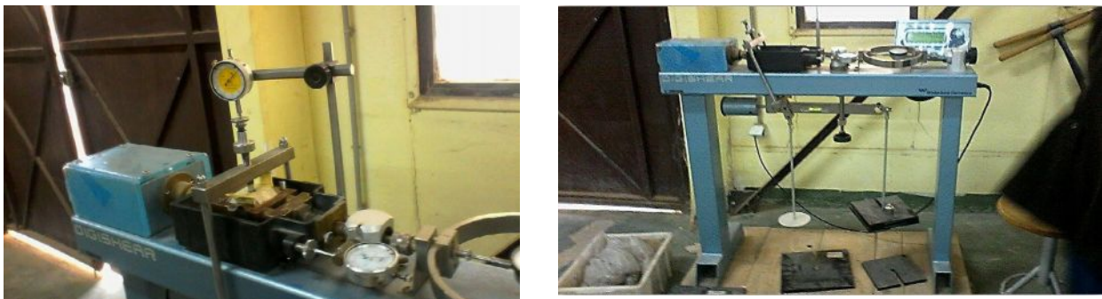
Figure IV.8: Boîte de cisaillement utilisée.
