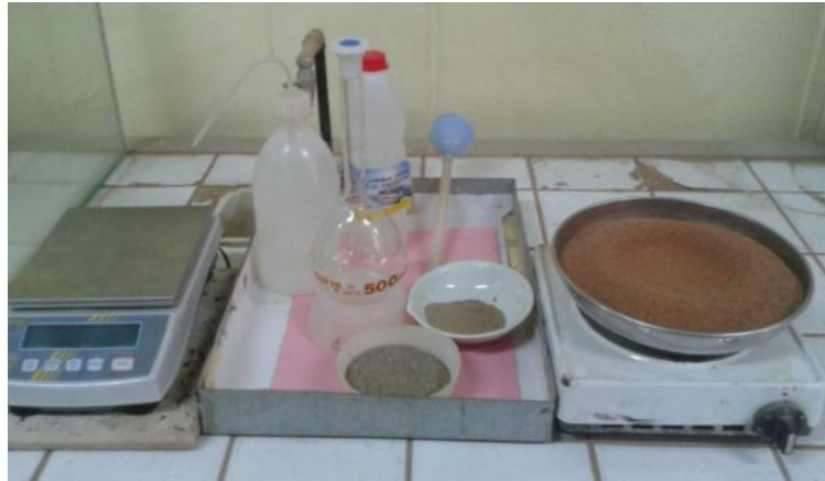
Figure 4.7: Essai au pycnomètre.
