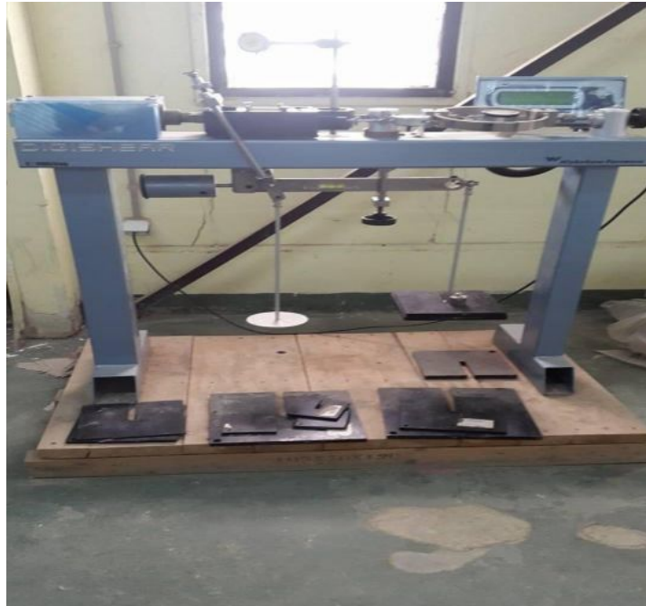
Figure 4.16: Photo de la boîte de cisaillement de direct du laboratoire de MDS.
