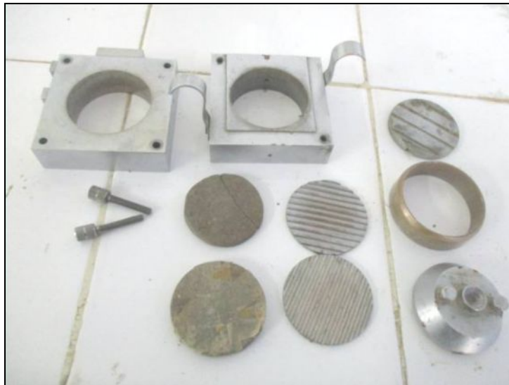
Figure IV.21: Boîtes de cisaillement + accessoires (section circulaire, \phi = 6\text{cm} )
