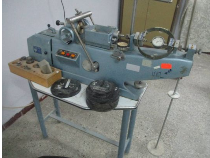
Figure IV.20: Vue d'ensemble de la boîte de cisaillement
