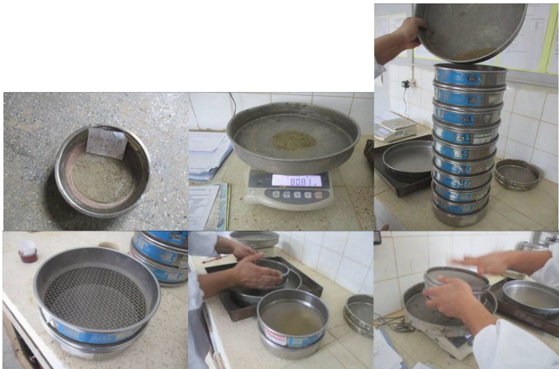
Figure IV.2: Mode opératoire l'essai analyse granulométrique par tamisage
