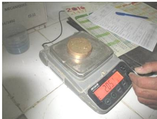
Figure IV.24: Détermination de la masse de l'échantillon
