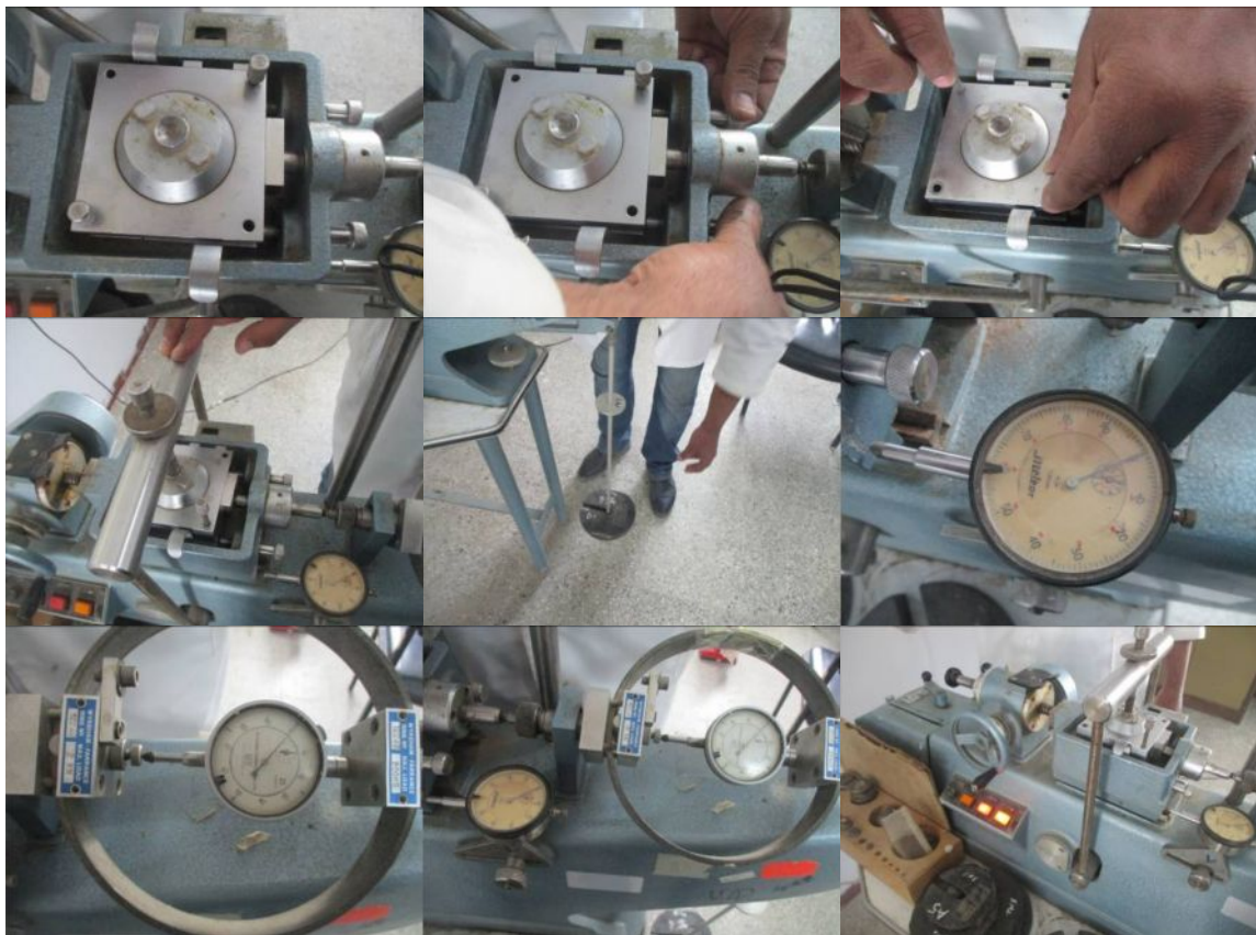
Figure IV.26: Mise en place de la boîte et réglage des comparateurs
