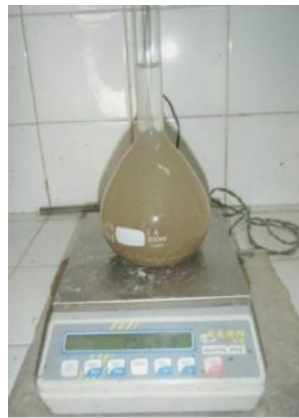
Figure IV.11: Mesure de la masse totale
