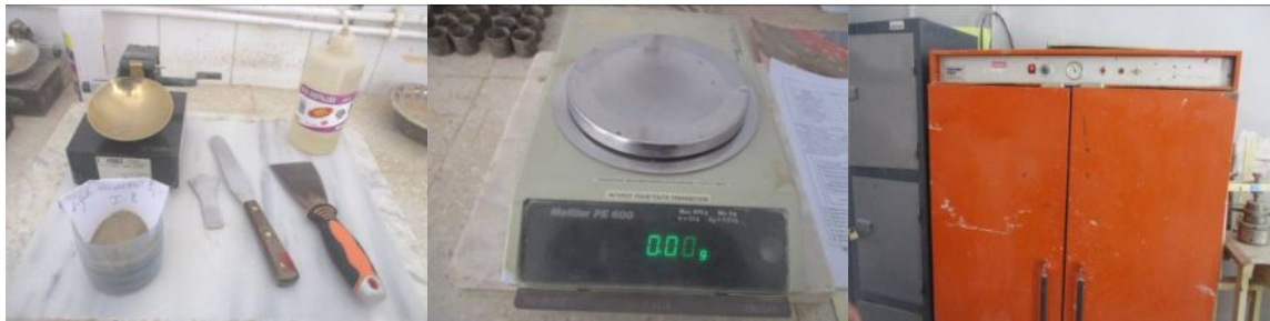
Figure IV.6: Matériel pour détermination de la limite de liquidité et la limite de plasticité
