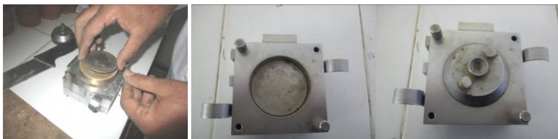
Figure IV.25: Mise en place de l'échantillon dans la boîte
