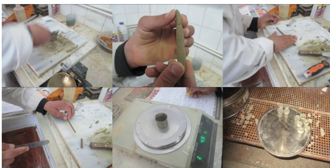
Figure IV.8: Mode opératoire pour détermination de la limite de plasticité
