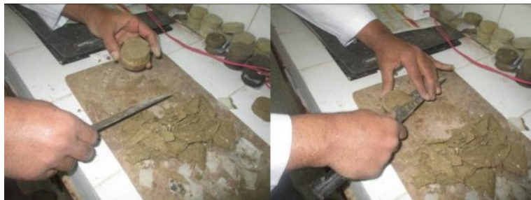
Figure IV.23: Préparation de l'échantillon (section circulaire \phi = 60\text{mm} )
