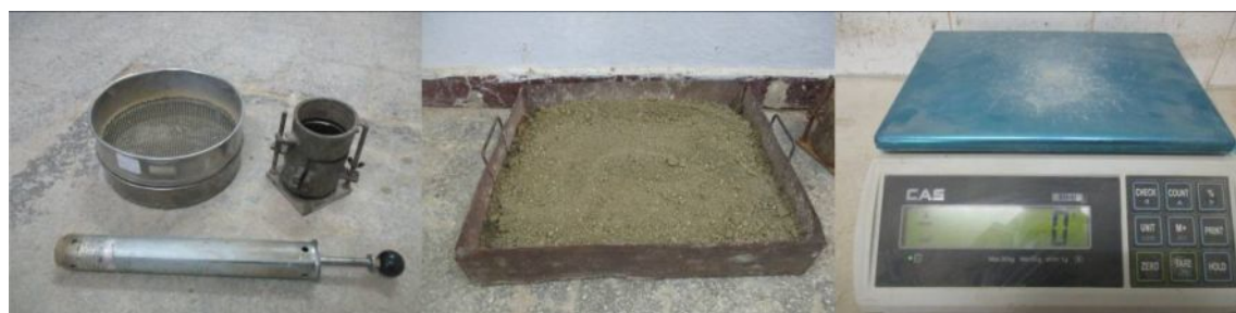
Figure IV.15: Appareillage pour l'essai Proctor
