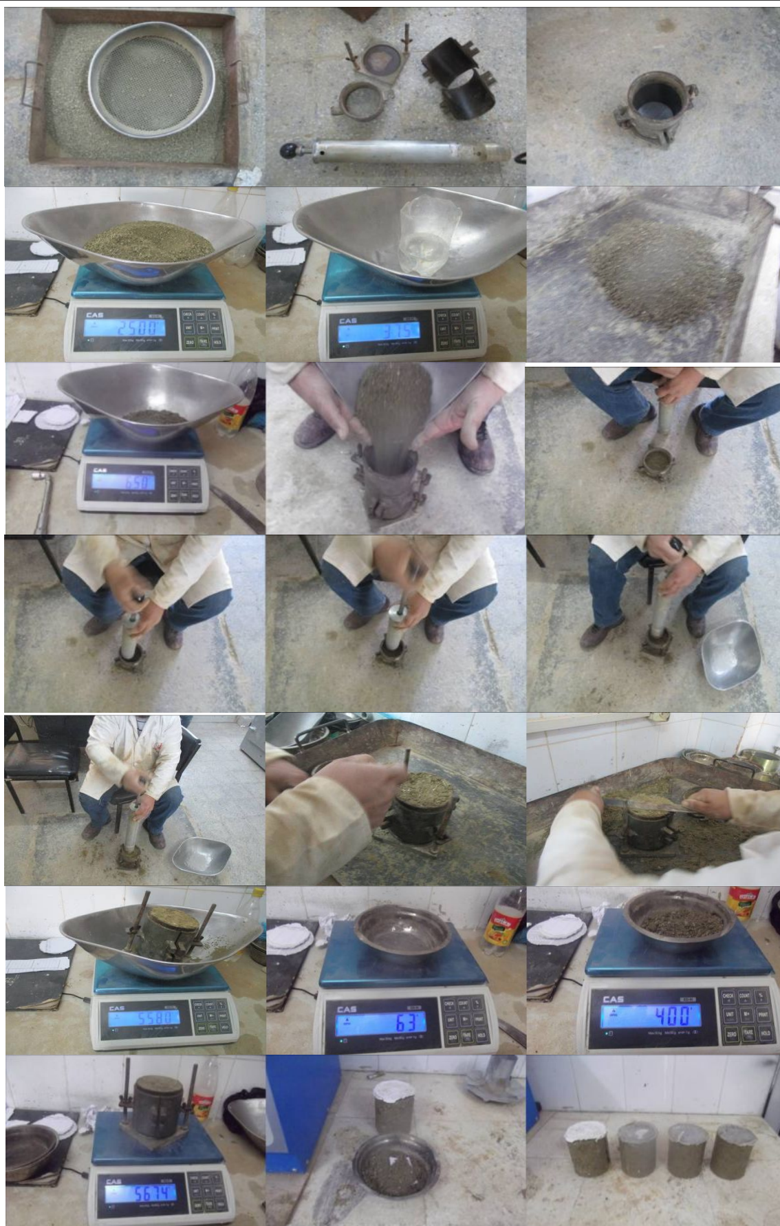
Figure IV.16: Mode opératoire de l'essai Proctor
