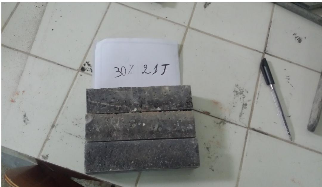
**Photo IV-3 : Identification des éprouvettes (le pourcentage -l'âge)**
