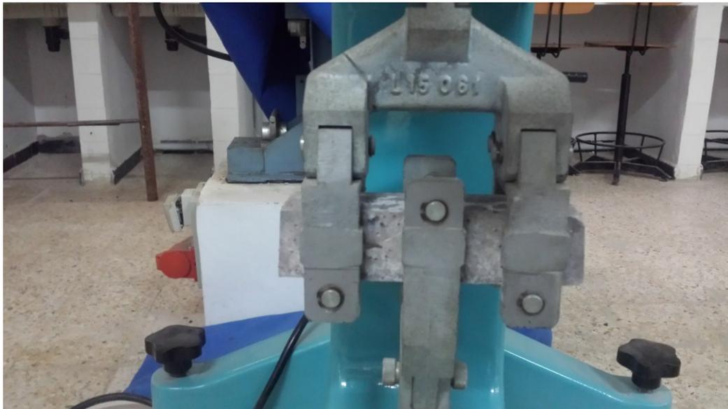
**Photo IV-6 : L'écrasement par l'appareil de l'essai de traction par flexion**
