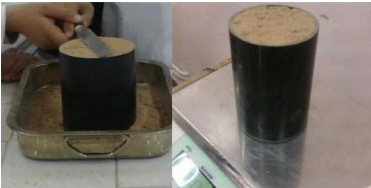
Photo III-1 : Essai de la masse volumique apparente.
