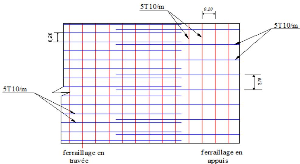
Figure VIII.2-Schéma de ferrailage voile périphérique
