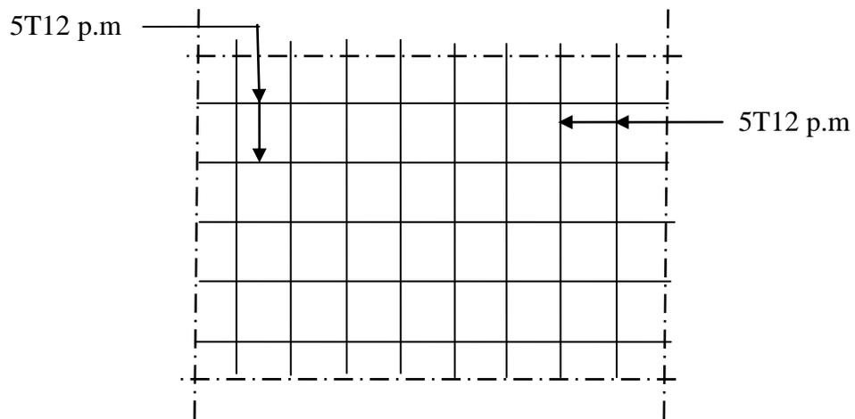
**Figure VII.2-**Disposition du ferrailage du voile.
