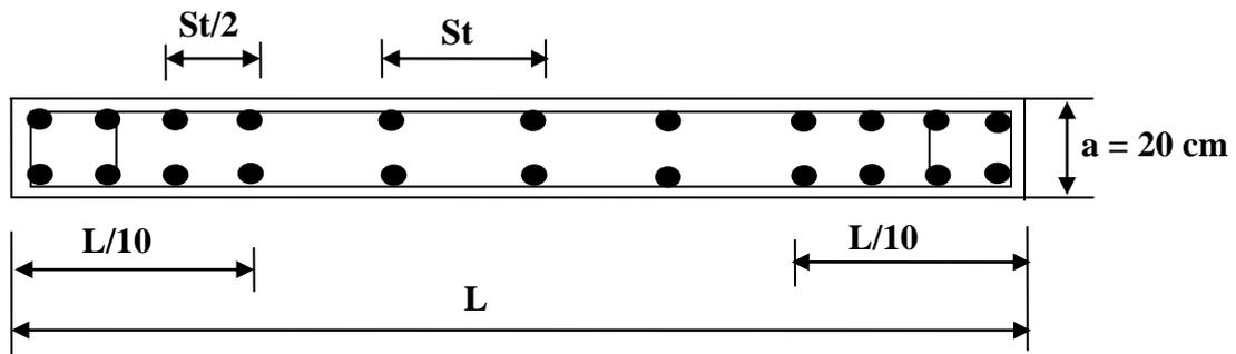
Figure VII.1-Disposition des armatures verticales dans les voiles.
