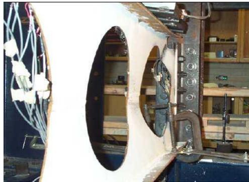
**Figure 2. 8.** Flambement du montant d'âme sous compression
