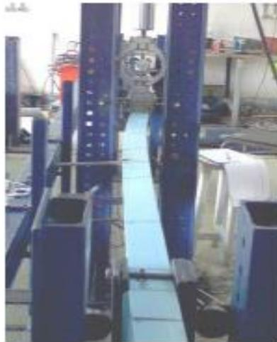
**Figure 2. 6.** Déversement d'une poutre cellulaire
