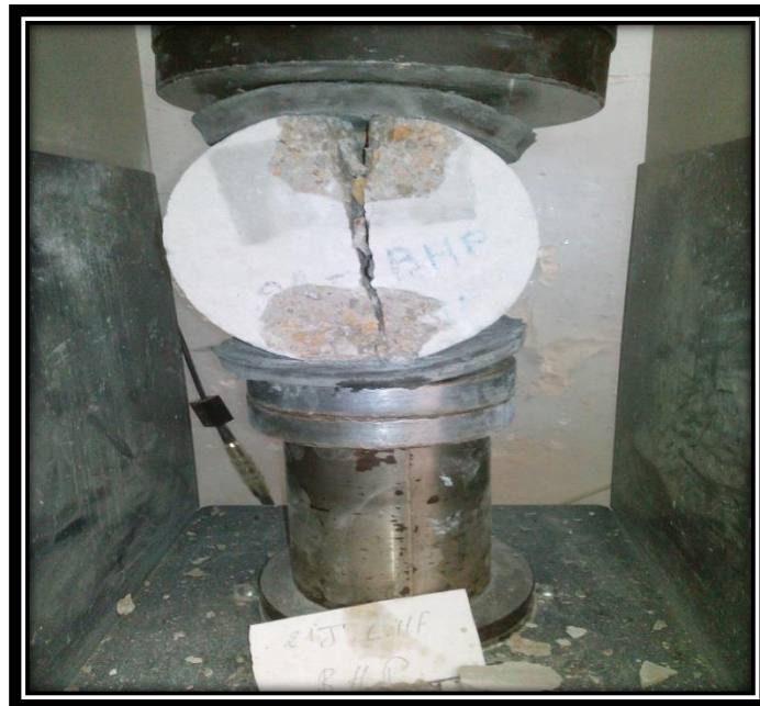
Figure IV.36 : Rupture d'éprouvette cylindrique à 28 jours (BHP)
