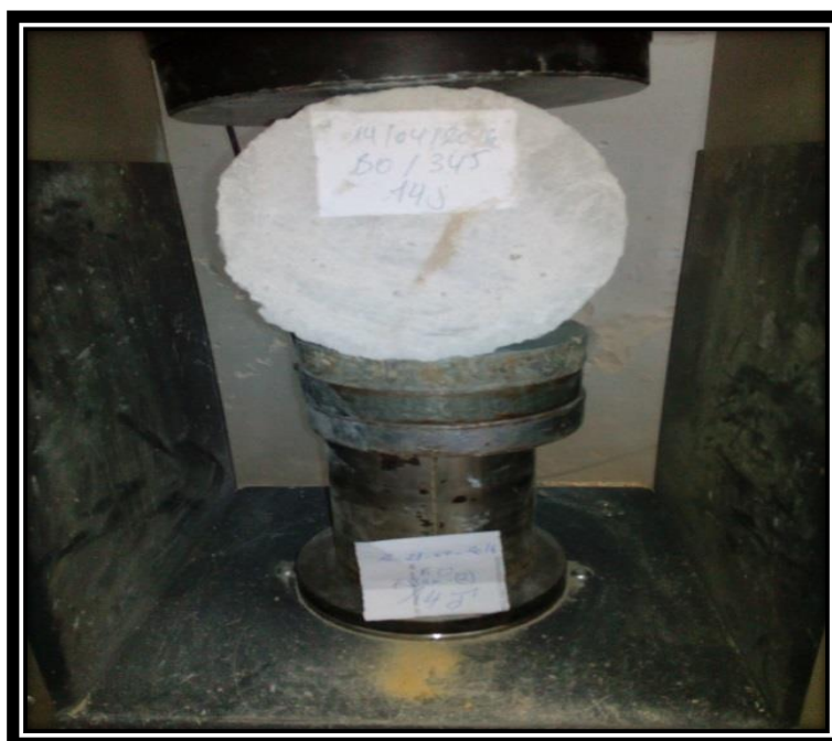
Figure IV.34 : Chargement d'essai de traction par fendage
