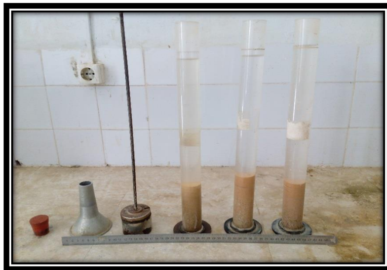
Figure IV.12 : Essai d'équivalent de sable (juste après agitation)
