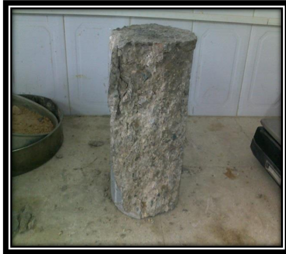
Figure IV.32 : Rupture des éprouvettes cylindriques à 28 jours (Béton ordinaire)
