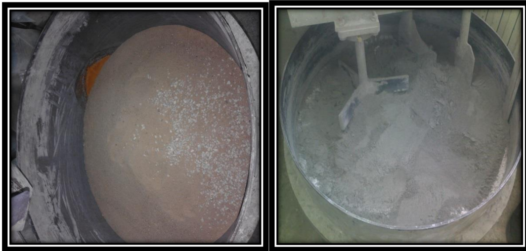
Figure IV.22 : Malaxage à sec des ingrédients du béton
