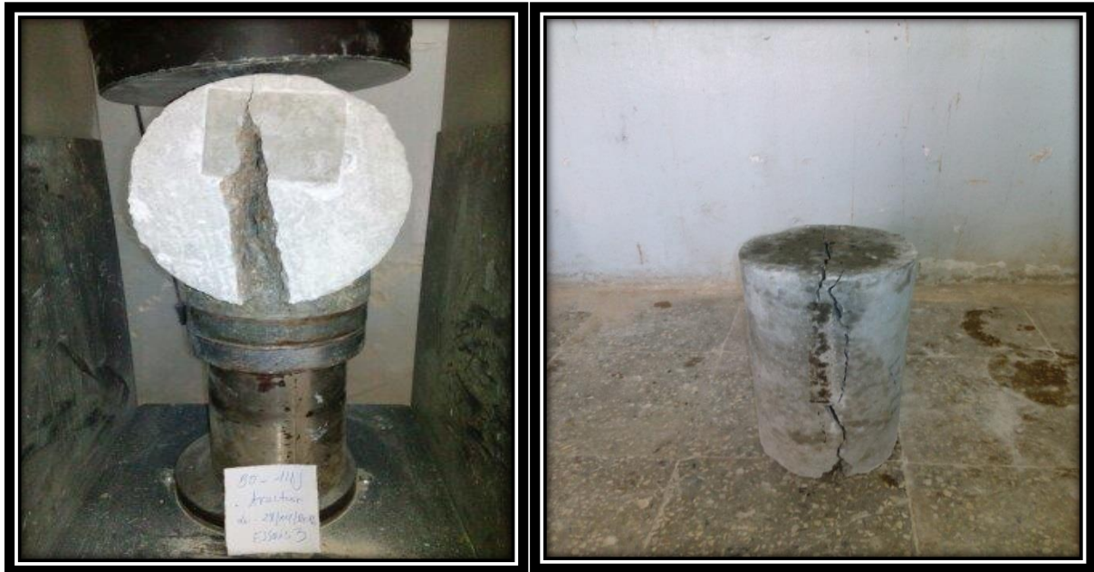
Figure IV.35 : Rupture des éprouvettes cylindriques à 28 jours (Béton ordinaire)
