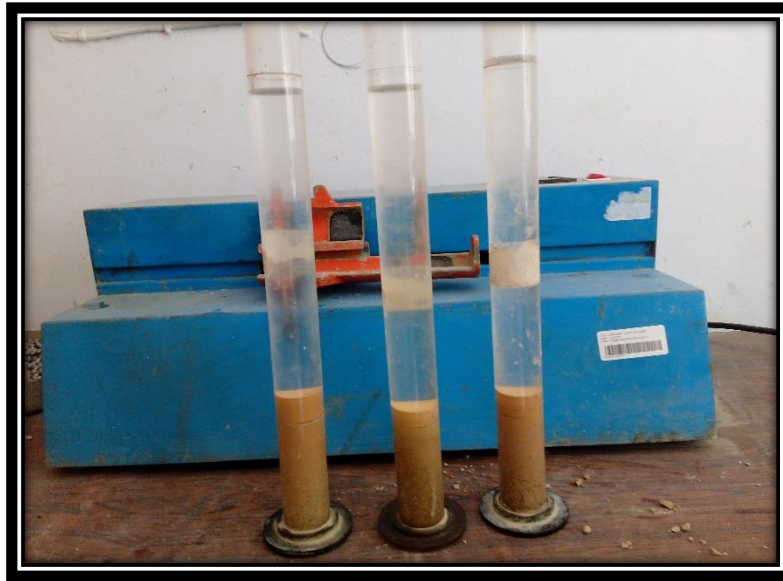
Figure IV.13 : Les trois éprouvettes pour l'essai de l'équivalent de sable ( E_s ) (phase de repos (20 mn))
