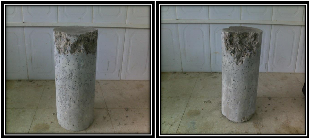
Figure IV.33 : Rupture des éprouvettes cylindriques à 28 jours Béton à haute performance BHP
