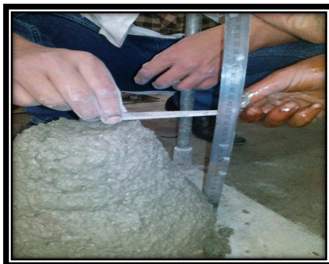
Figure IV.24 : Mesure de l'affaissement du béton
