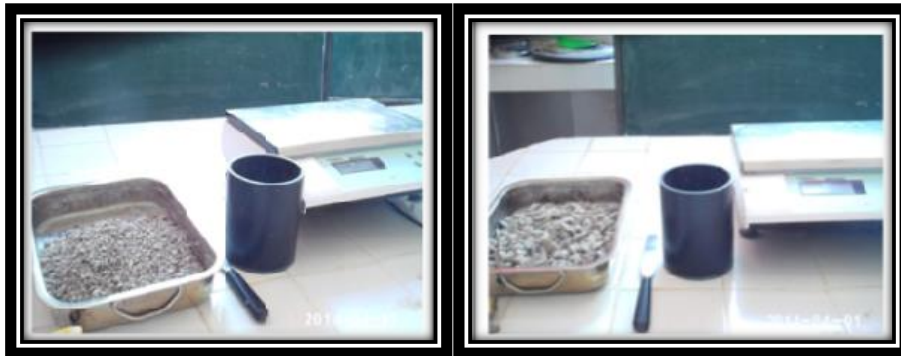
Figure IV.16 : Essai de la masse volumique du gravier 3/8 et 8/15
