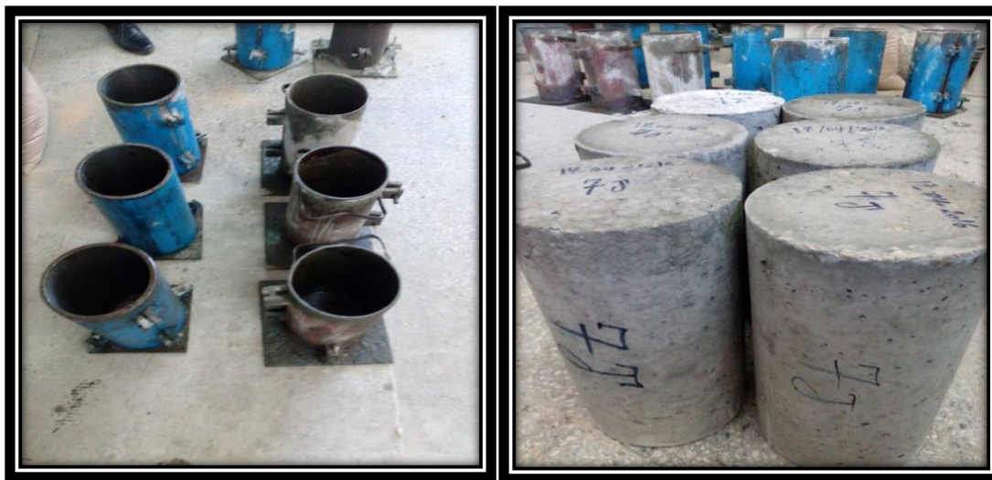
Figure IV.28 : Démoulage des éprouvettes cylindriques
