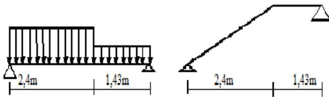
**Figure 7 Schéma statique d'une volée + paliers.**
