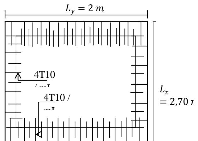
Figure 17 : ferrailage de la dalle d'ascenseur
