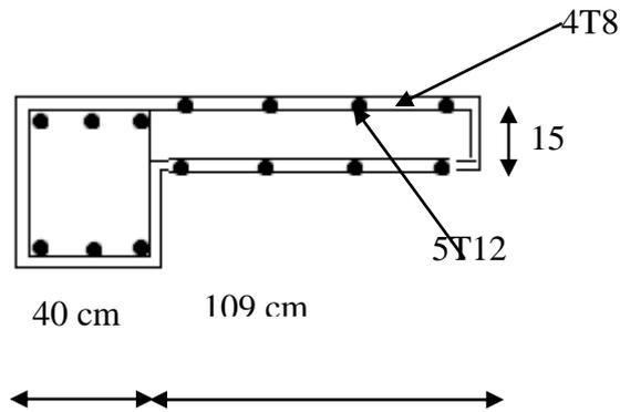
**Figure 11 Ferrailage premier type de balcon.**
