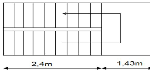
Figure 6 : schéma d'un escalier à deux volées
