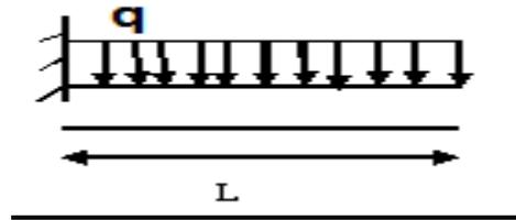
**Figure 4: schéma statique de la marche**
