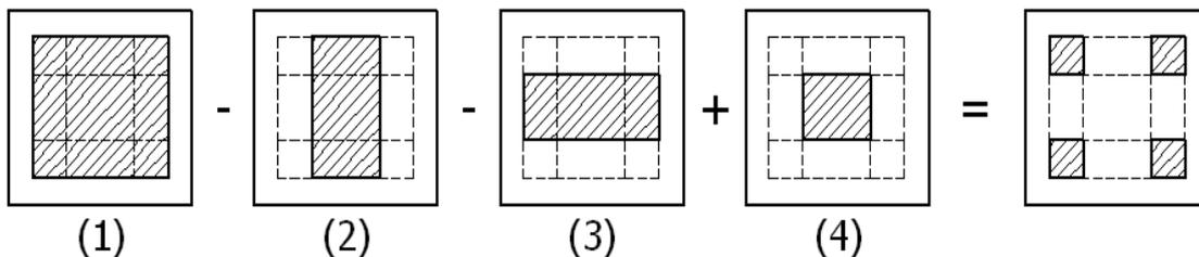
**Figure 14 : Schéma expliquant la concentration des charges sur la dalle**
