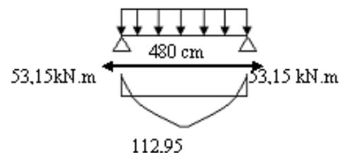
**Figure 9 : Diagramme des moments que subit la poutre palière.**
