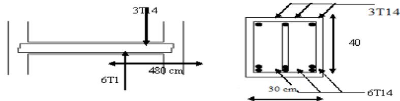
**Figure 10 : Ferrailage de la poutre palière.**
