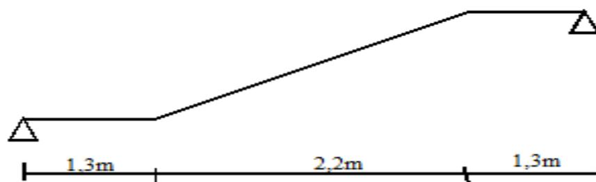
**Figure 3 Schéma statique d'une volée + 2 paliers.**
