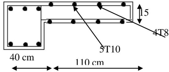
**Figure 12 : Ferrailage du second type de balcon**
