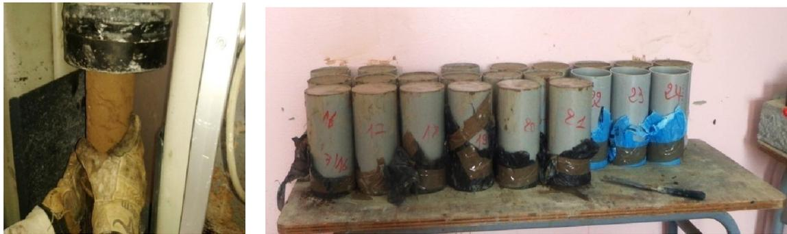
**Photo (III.5): Soufrage des éprouvettes avant l'essai de compression**
