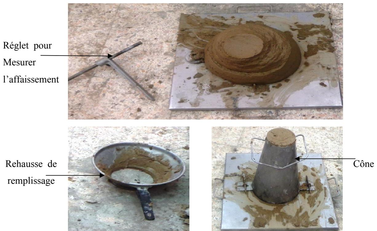
**Photo (III.4) : Détermination de l'affaissement au cône d'Abrams a) Matériel de l'essai
