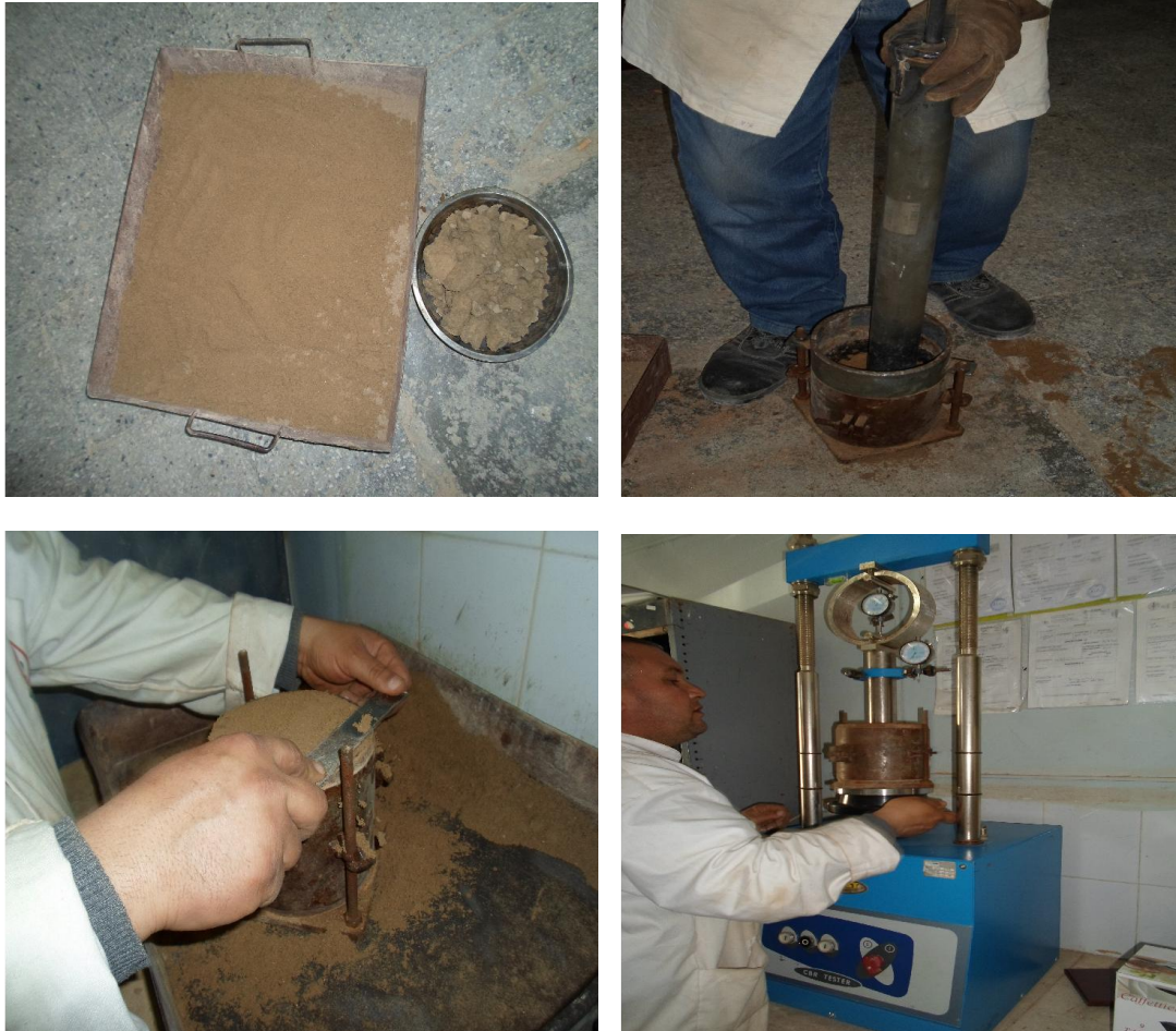
Photo (II.6): essais de Proctor modifié
