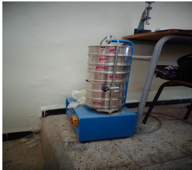
Photo (II.3) : Matériels de l'essai de l'analyse granulométrique (série des tamis +agitateur)
