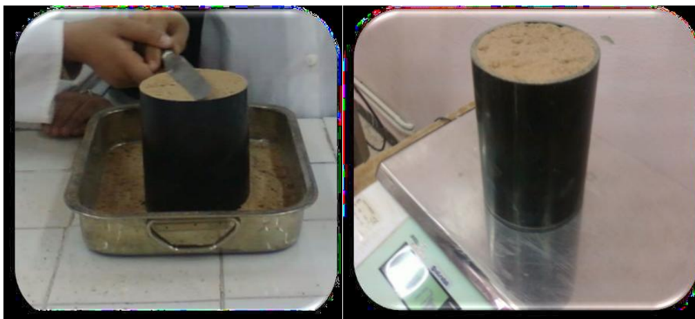
Figure. III. 9: Essai de la masse volumique apparente.
