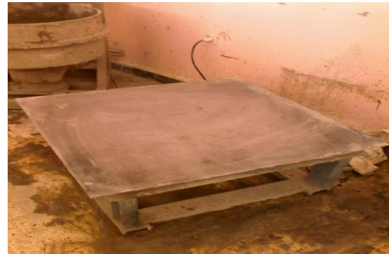
Figure.III.16 : la table de chocs.
