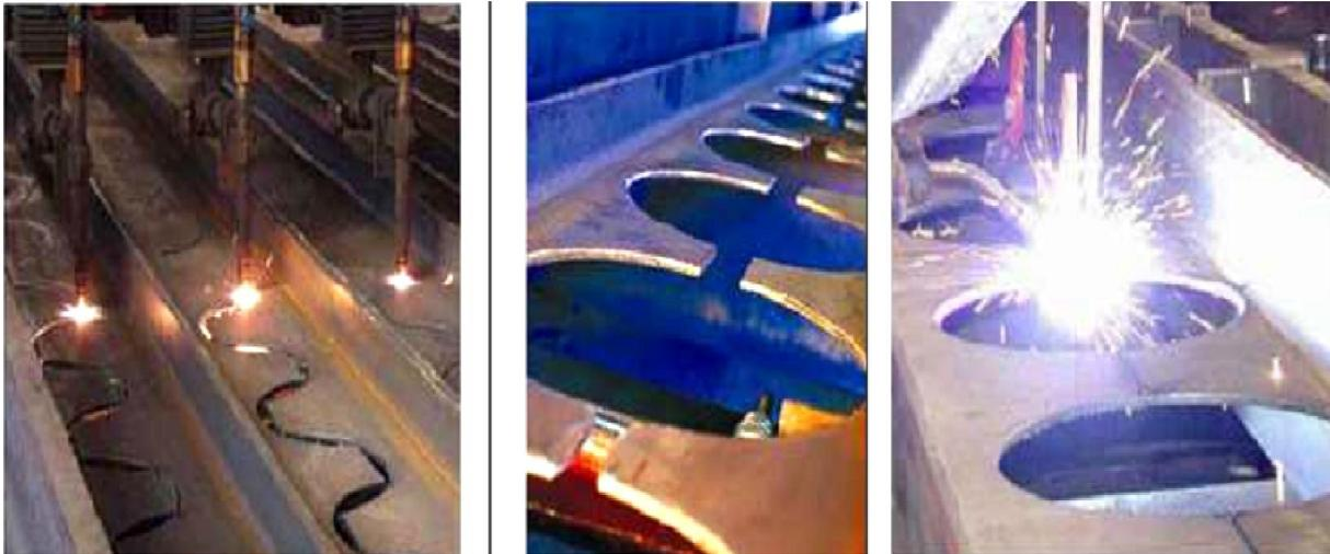
Fig.1.5 : Oxicoupage du profilé de base, séparation et soudage des deux parties [1].
