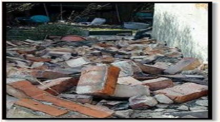
**Photo (II.8) : Agrégats pour béton in situ et préfabriqué et mortiers**
