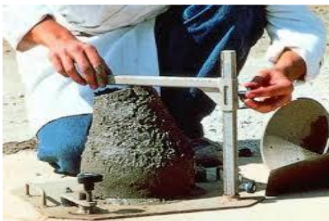
Photo (I.3) : Mesure de l'affaissement
