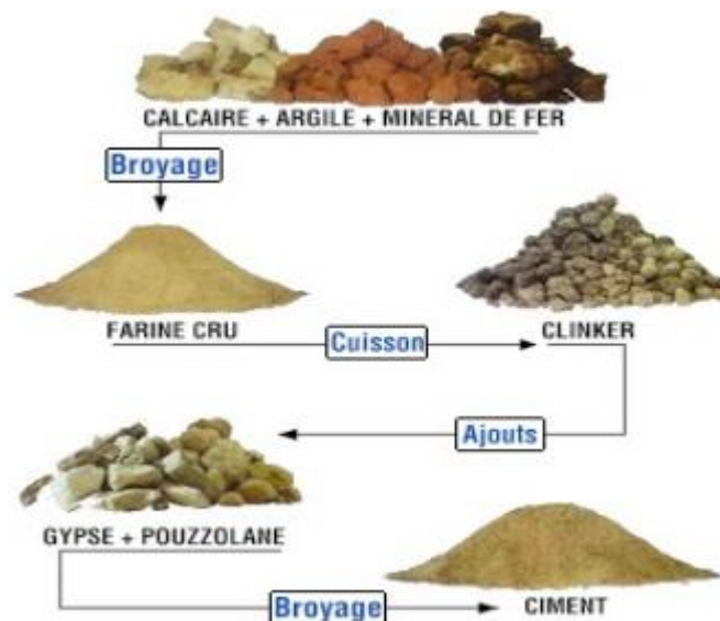
Figure (I.2) : Constituant de base du ciment
