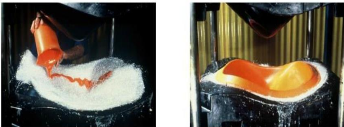
Figure I.23 : Principe du Moulage par compression à chaud de résine [25].
